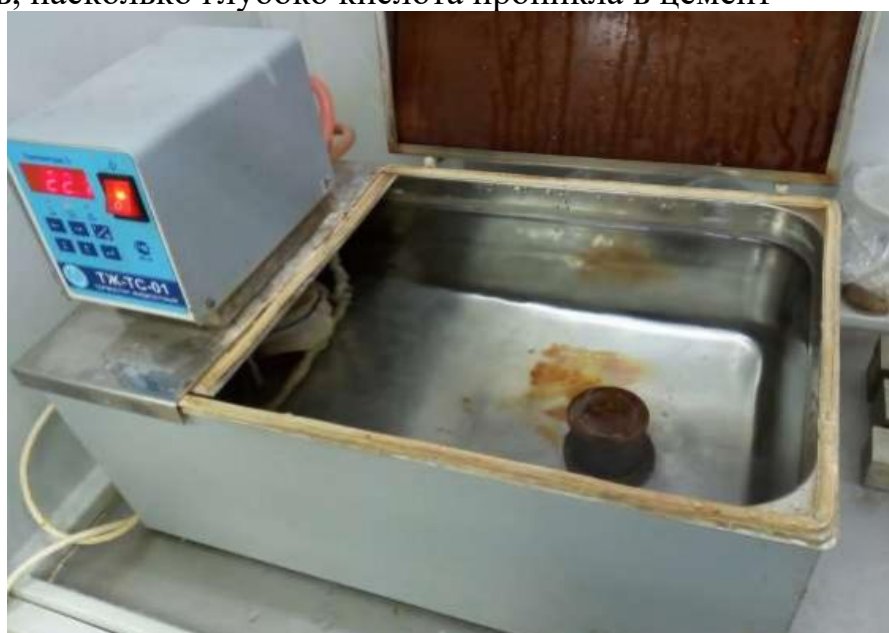
Рисунок 2.3 – Испытание на кислотоустойчивость
