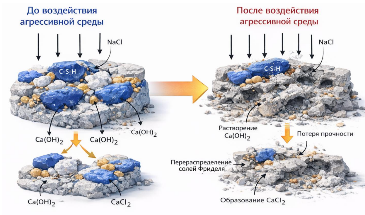
Рисунок 4.10 – Схематичное изображение процессов коррозии и деградации цементного раствора
