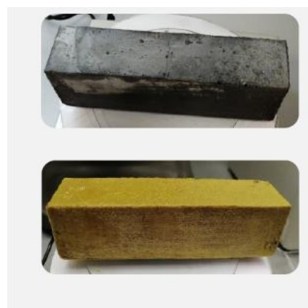
Рисунок 2.4 – Результаты испытания на кислотоустойчивость
